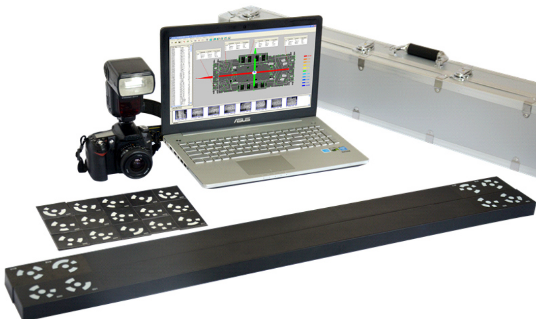
Рисунок 4 - Общий вид прибора оптического координатно-измерительного фотограмметрического DigiMetric
